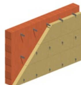
3. APLIKACE TEPELNÉ IZOLACE
