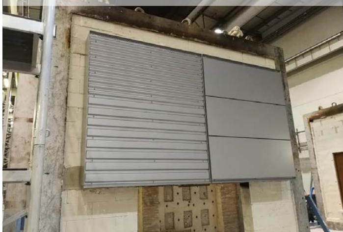
4. ZEĎ PO 120 MINUTÁCH. NEPORUŠENÁ NOSNÁ KONSTRUKCE I POHLEDOVÉ PRVKY
