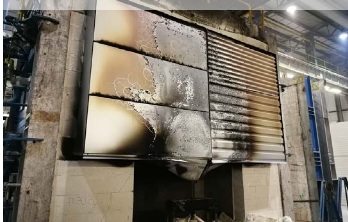
4. ZEĎ PO 120 MINUTÁCH. NEPORUŠENÁ NOSNÁ KONSTRUKCE I POHLEDOVÉ PRVKY
