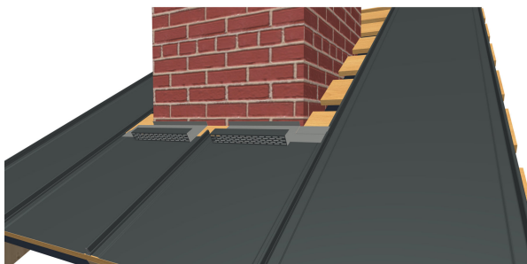
[OBR_29: Detail přípravy spodní části pro osazení spodního plechu lemu komínu]
